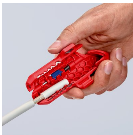
Skidanje plašta kabela NYM
