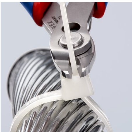
Za rezanje u ravnini, npr. za skraćivanje kabljskih spojnica
