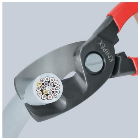
Finalni rez: nakon što je plašt kabela presječen u prednjem profilu, sijeku se vodiči u stražnjem profilu. Inicijalni rez Početni rez: rezanjem izolacije kablova većih promjera prednjim oštricama uz ergonomsku širinu otvora ručki. sprijeda, finalni rez straga - tako se lakše siječe.
