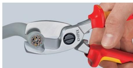
Finalni rez: nakon što je plašt kabela presječen u perdnjem profilu, sijeku se vodiči u stražnjem profilu. Inicijalni rez Početni rez: rezanjem izolacije kablova većih promjera prednjim oštricama uz ergonomsku širinu otvora ručki. sprjeda, finalni rez straga - tako se lakše siječe.
